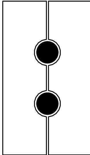
Figura 16 — Calços com furos alongados até uma borda
