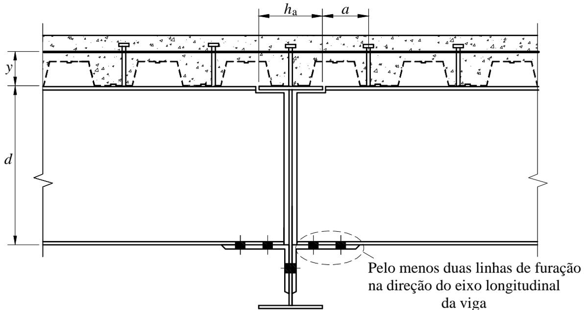
Figura R.3 — Ligação mista com cantoneira parafusada na mesa inferior da viga apoiada
