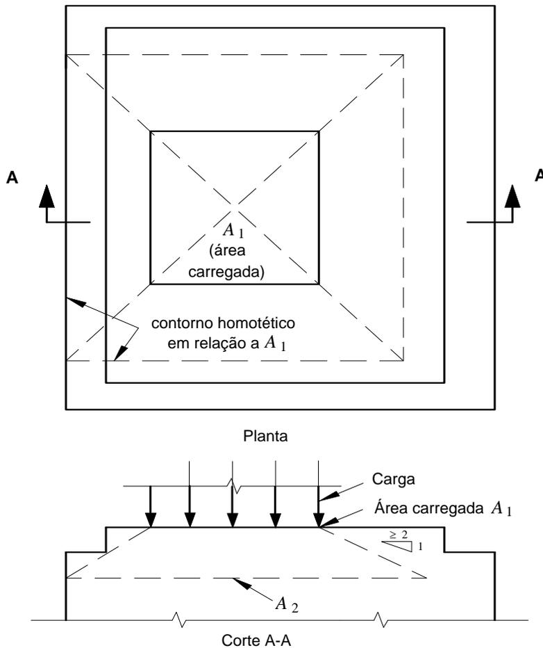
Figura 22 — Pressão de contato sobre apoios de concreto
