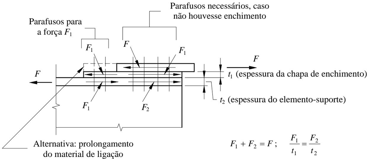
Figura 21 — Chapa de enchimento em ligações parafusadas
