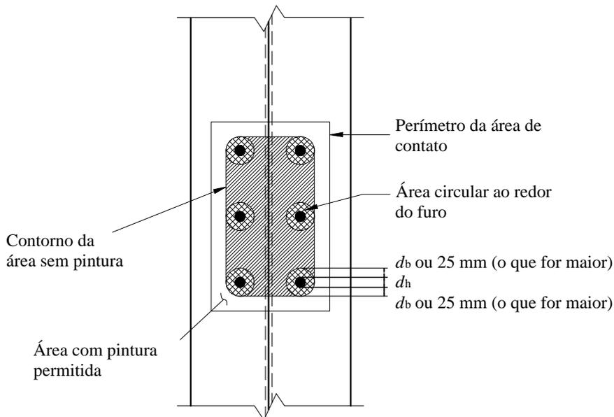
Figura 15 — Superfícies em contato sem pintura
