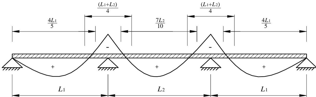
Figura O.3 — Distâncias simplificadas entre os pontos de momento nulo em uma viga contínua ou semicontínua
