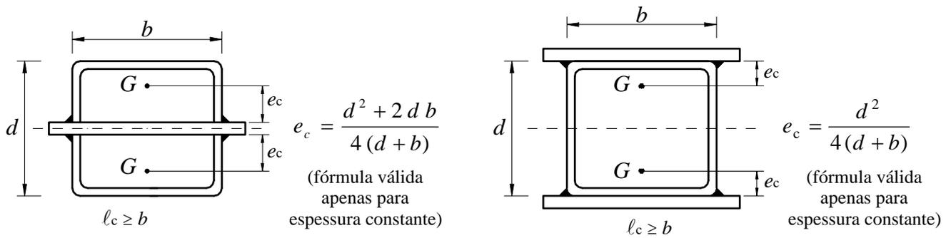
Figura 7 — Ilustração do valor de  $e_c$  em seção tubular retangular
