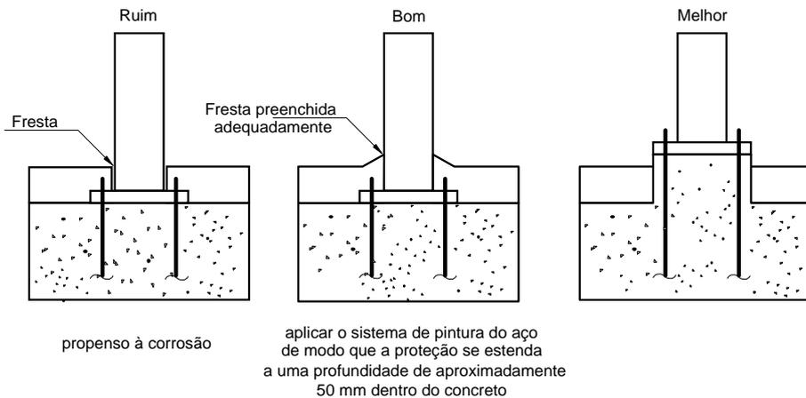
Figura N.2 — Transição entre aço e concreto
