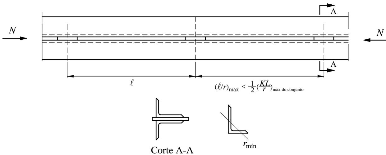
**Figura 12 — Barra composta comprimida**
