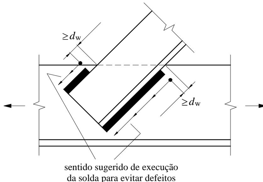
**Figura 14 — Filetes de solda próximos de bordas tracionadas**
