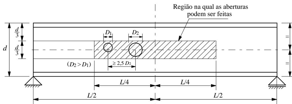
**Figura I.1 — Condições para execução de aberturas circulares**
