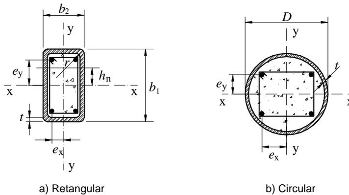
**Figura P.5 — Seção tubular preenchida com concreto**
