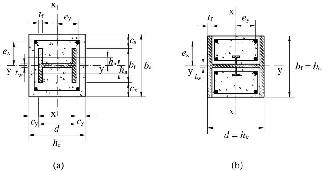
Figura P.4 — Seção I ou H revestida com concreto fletida em relação ao eixo y
