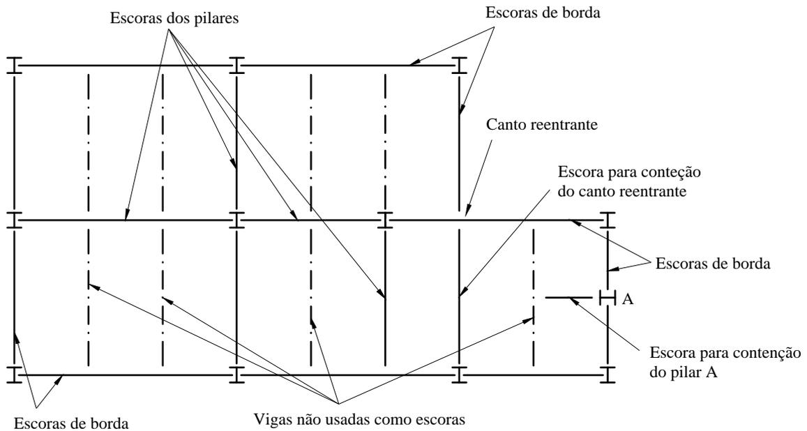
Figura 3 — Exemplo de escoramento dos pilares de um edifício
